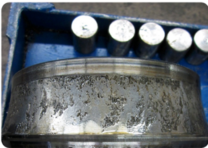
Fig. 10: Condizioni potenzialmente dannose. Affaticamento e usura superficiali nonostante la lubrificazione adeguata.
