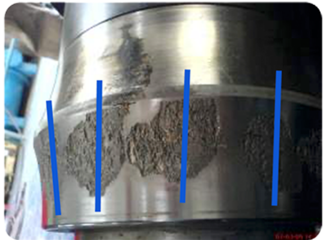
Fig. 10: Condizioni potenzialmente dannose. Erosioni precoci e profonde a passo rulli.
