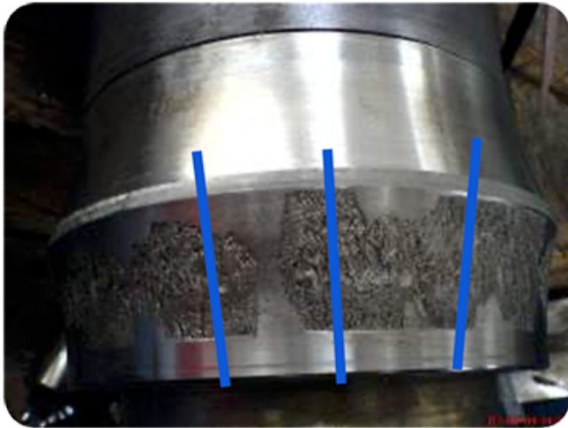
Fig. 10: Condizioni potenzialmente dannose. Erosioni precoci e profonde a passo rulli.
