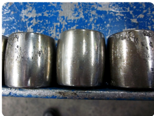
Fig. 10: Condizioni potenzialmente dannose. Affaticamento e usura superficiali nonostante la lubrificazione adeguata.
